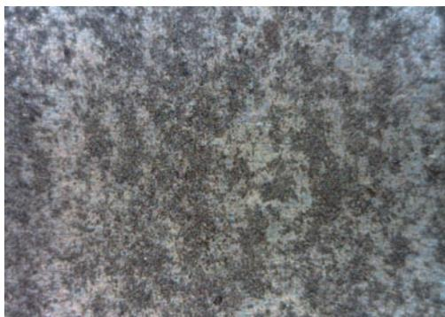
Die Abbildung (1) zeigt ein Digitalmikroskop-Bild in sechzigfacher Vergrößerung einer korrosiv angegriffenen Lauffläche eines Schmitzrings.
